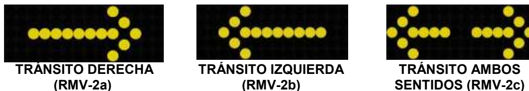
FIGURA 6.304.303(4).A SEÑAL TIPO SENTIDO DE TRÁNSITO
